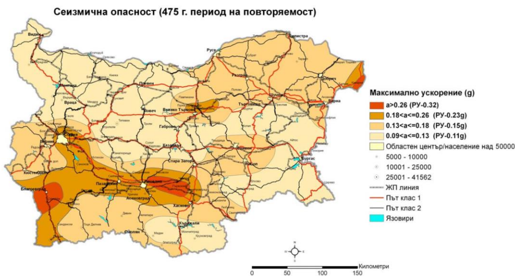
Фигура 6.6.1. Сеизмична опасност (475г. период на повторяемост) за община Пловдив 291
